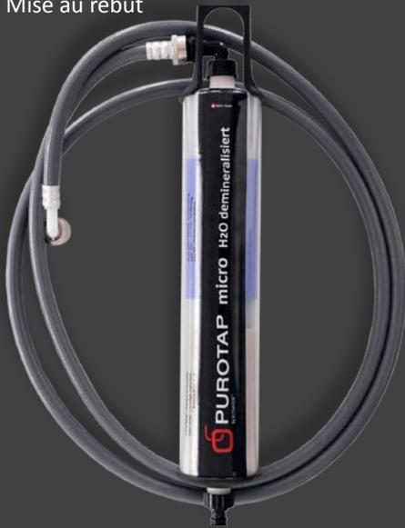
Le rendement (l/min) est fonction de la teneur en sels de l'eau brute. Plus la teneur en sels est élevée et plus le rendement sera faible. La durée de vie utile de la cartouche filtrante dépend des impuretés présentes dans l'eau brute. Les matières en suspension, les particules de rouille, les impuretés organiques, etc. réduisent la durée de vie utile de la membrane de filtration.
